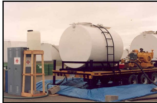
Figure 2.1 Citerne mobile dans un aménagement de rétention
