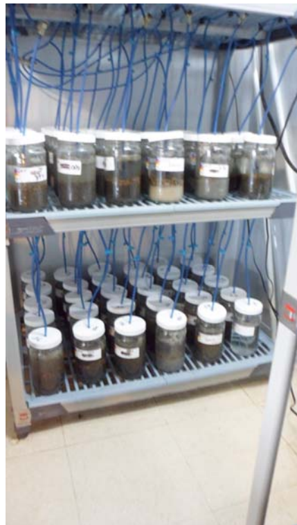
Figure 5 : Montage expérimental utilisé pour l'exposition des œufs de mené à grosse tête dans les salles environnementales de l'INRS-ETE
