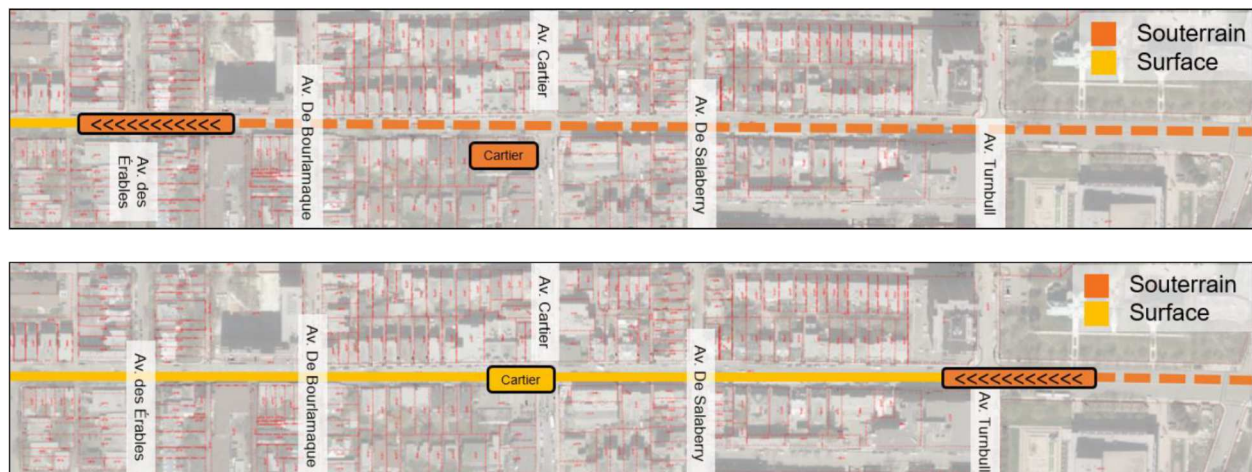
FIGURES 1 ET 2 LOCALISATION DE LA TRÉMIE SELON LES OPTIONS DE TUNNEL LONG ET COURT
