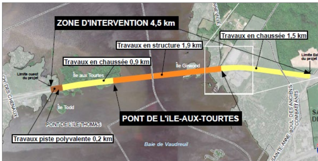
Figure 1 : Localisation du pont de l'Île aux Tourtes
