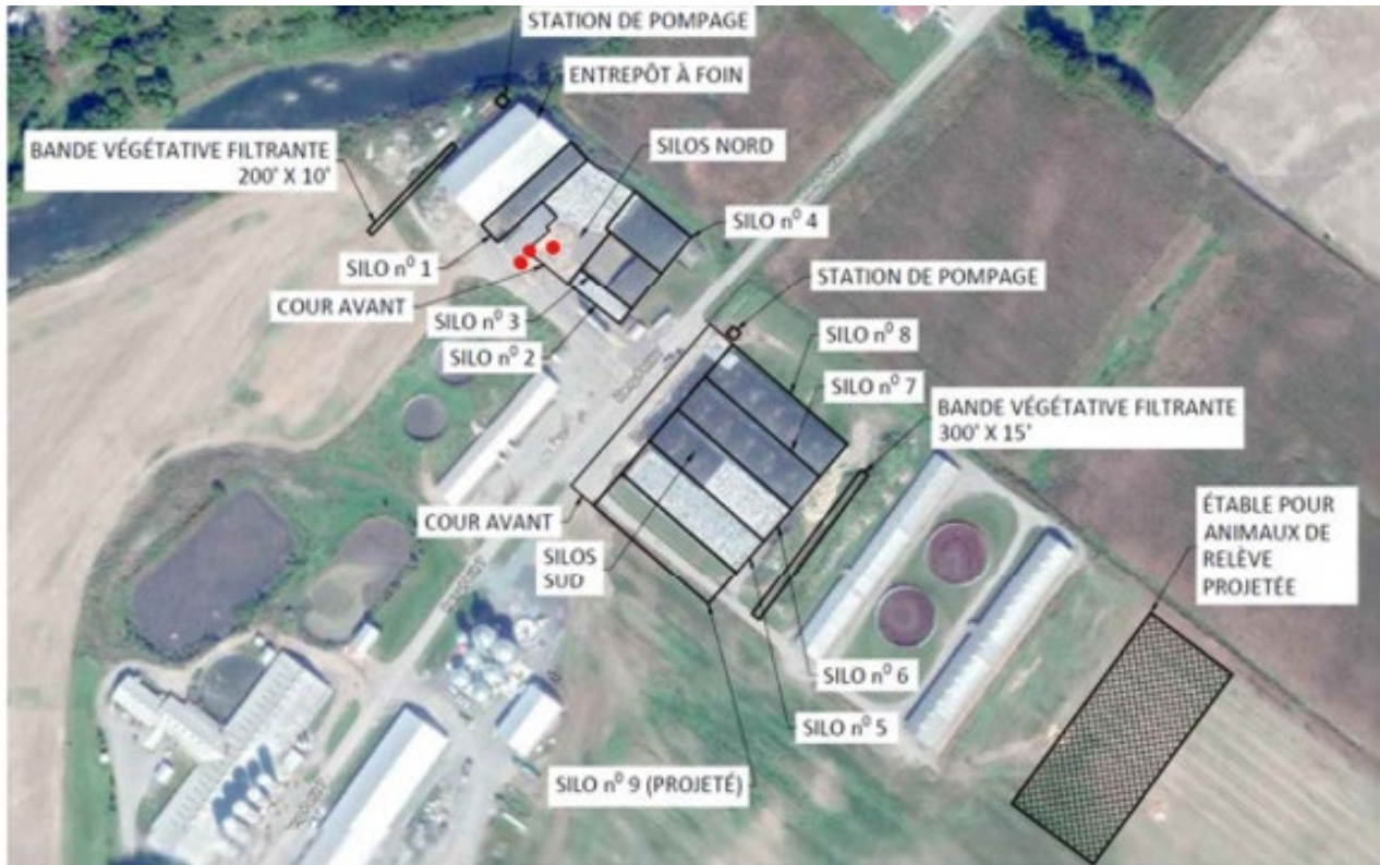
FIGURE 3 : EMPLACEMENT SILOS FOSSES ET DES BANDES VÉGÉTATIVES FILTRANTES SUR LA FERME LANDRYNOISE
