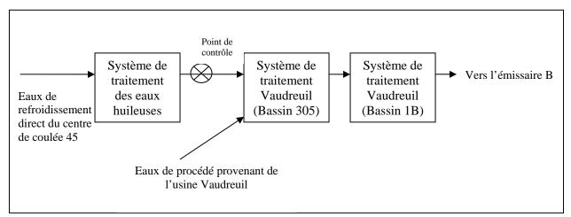
FIGURE 7: TRAITEMENT DES EAUX DE REFROIDISSEMENT DIRECT DU CENTRE DE COULÉE 45
